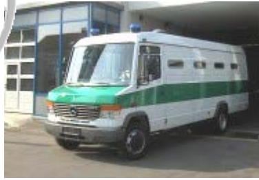
MB 815D verlängert um 550mm, Ausbau als Gefangenentransporter
