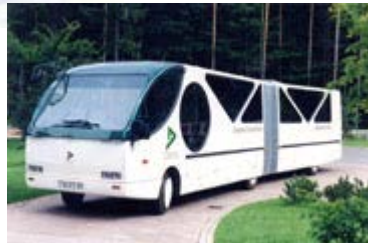
Elektro-Solar-Gelenkbus als Shuttle
